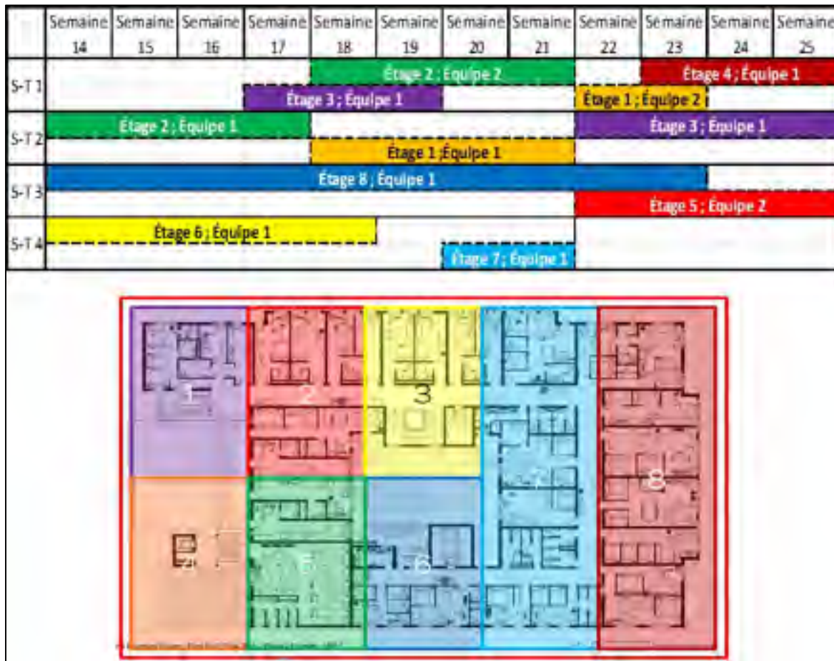
Figure 3.4 Combinaison d'un plan d'étage et d'un échancier Gantt modifié adaptée de Prats (2016)
