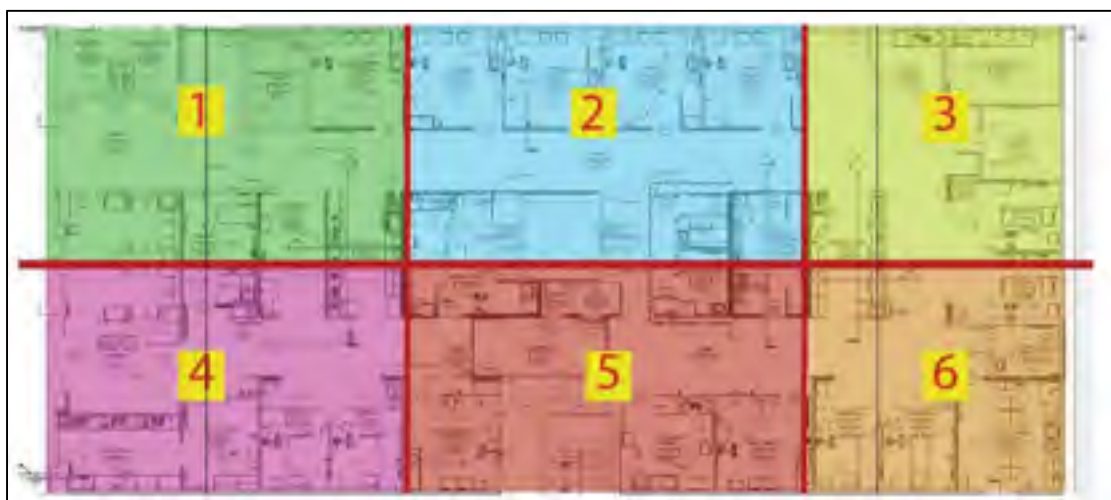
Figure 1.14 Découpage de l'étage avec l'utilisation du Takt-Time Tirée de Frandson et Tommelein (2014, p. 1650)
