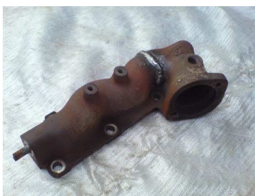
Рис. 2 - Приклади ремонтного зварювання чавунних деталей
