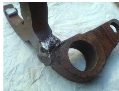
Рис. 2 - Приклади ремонтного зварювання чавунних деталей
