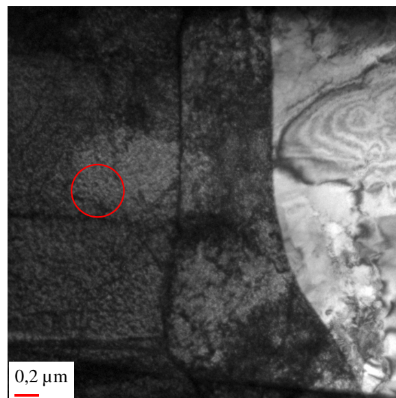
Abbildung 11.28.: Hellfeldaufnahme einer partiell reduzierten CeO_{2-0,072} -Probe (Reduktion: 1698 K, pO_2 = 4E-9 \text{ atm} ). Der SAED ist rot markiert.
