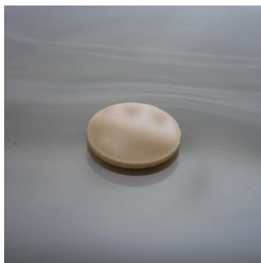
Abbildung 9.2.: Darstellung eines Ceroxidpellets (13 x 1 mm) nach einer Temperaturbehandlung bei 1650\text{ °C} .
