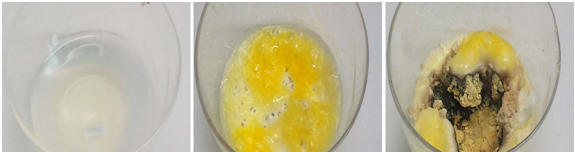
Abbildung 7.2.: Momentaufnahmen einer Pechini-Synthese. Abbildung der wässrigen Lösung zu Beginn der Synthese (links), nach Verdampfung bei 200 °C (mittig) und Zersetzung bei T > 300\text{ °C} (rechts).
