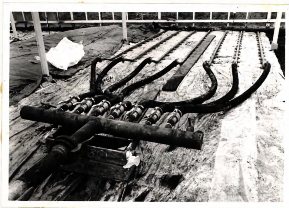
Foto 2. Noors traprek met verdeelstuk. De schotels moeten goed afsluiten, daar anders de stoom direkt naar boven ontwijkt.
