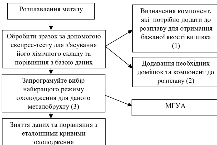
Рис. 1. Блок-схема створення литого сплаву
