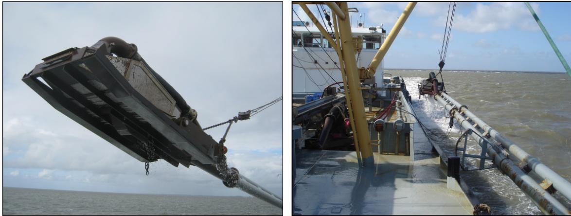
Figuur 5. De bemonstering is uitgevoerd met de zuigkor (links) welke wordt bediend vanaf de YE42 (rechts). Het monster wordt via een zuigbuis (rechts) opgezogen en vervolgens aan dek gezeefd in een spoelmolen met een maaswijdte van 5 mm.
