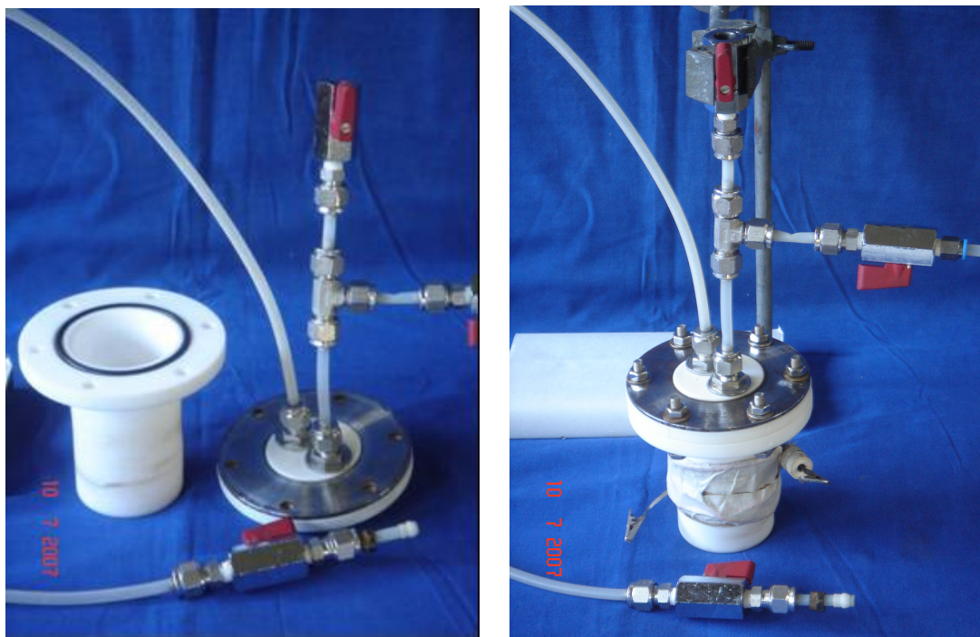
Figura 4. “Fotografias das vistas laterais da unidade compacta desacoplada e acoplada à tampa, mostrando as duas conexões em painel de 1/4”.
