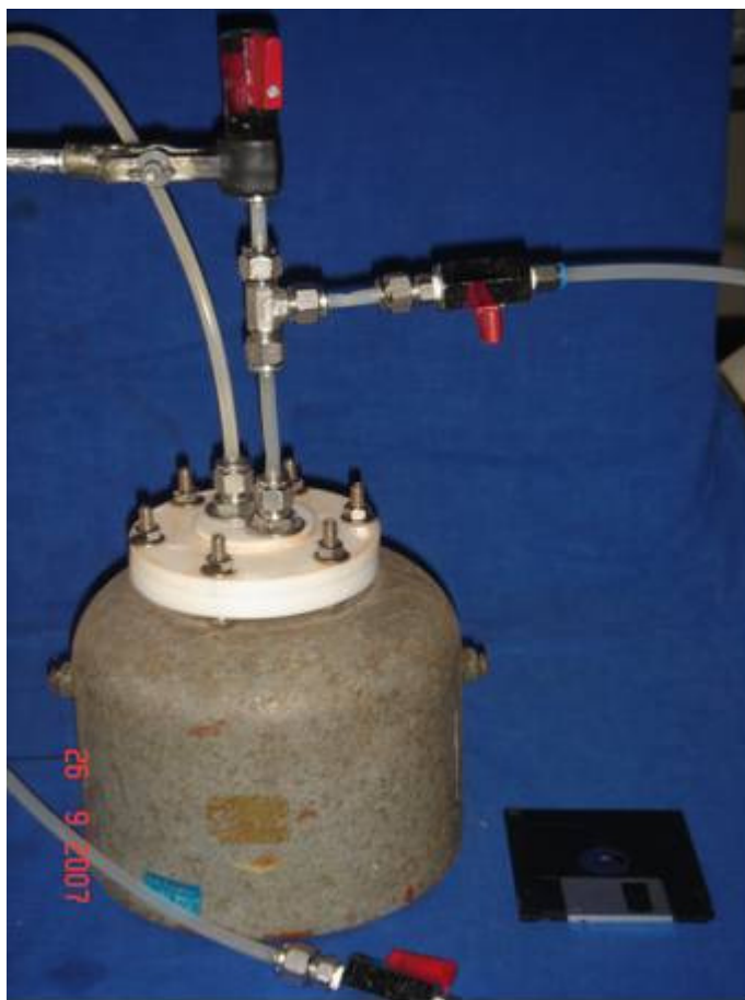
Figura 3. Castelo de chumbo acoplado a unidade compacta
