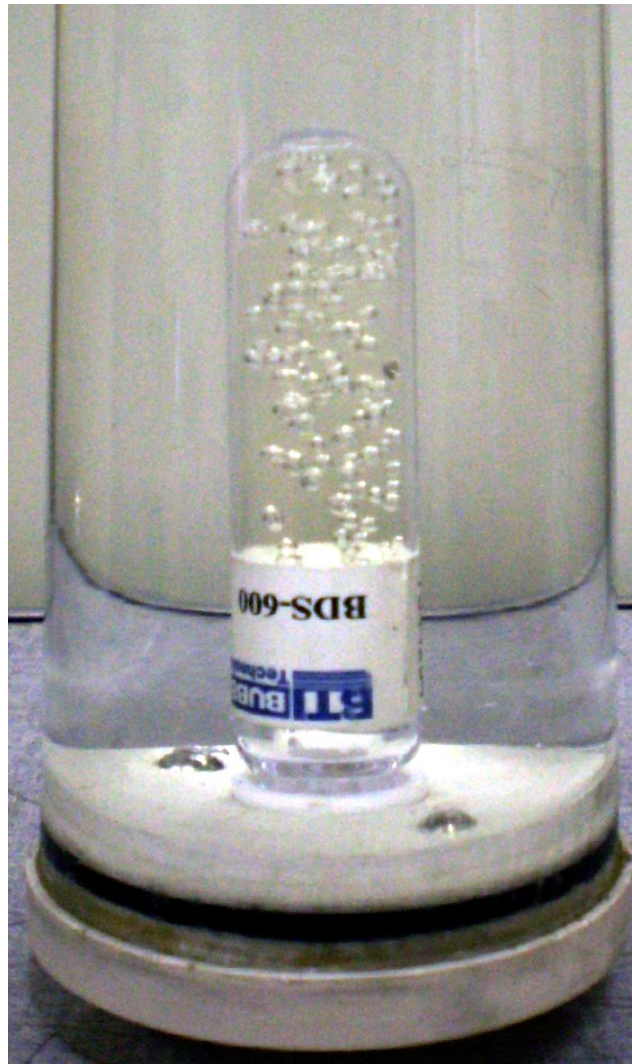
Figura 3. Dispositivo que envolve o tubo detector com água para amplificação da visualização das bolhas.
