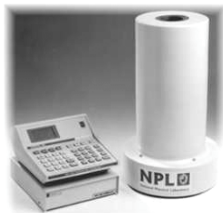
Figura D.3: Calibrador comercializado pela empresa inglesa Southern Scientific Ltd. com unidade da câmara de ionização desenvolvida pelo NPL e com console do calibrador de dose modelo 15 R da empresa Capintec.
