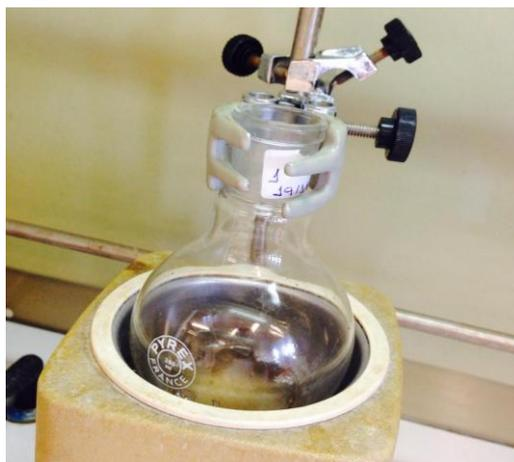
Figura 15 – Extração com clorofórmio das amostras liofilizadas.
