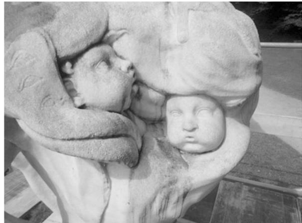
**Abb. 6:** Endstadium der Rauheit bei Sterzinger Marmor. Die Einzelkristalle treten markant hervor.
