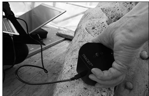
Abb. 10: Messung der Rauheit einer Marmoroberfläche durch Aufsetzen des Messkopfes (Foto: Irene Köhler 2016)
