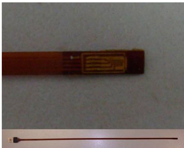
Fig. 2 The MOSkin dosimeter
