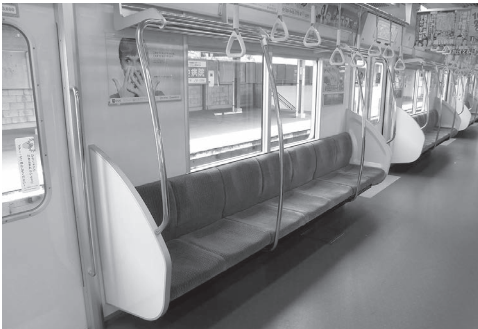
図1 車両内のスタンションポール（まちはち交通センターより転載）
