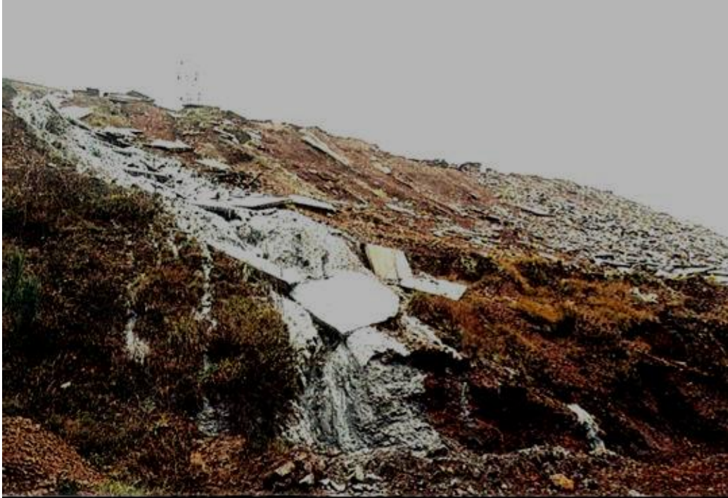
Figura 2.18 - Pormenor do escoamento resultante das operações de corte e polimento das rochas ornamentais (Moreno, 2000).
