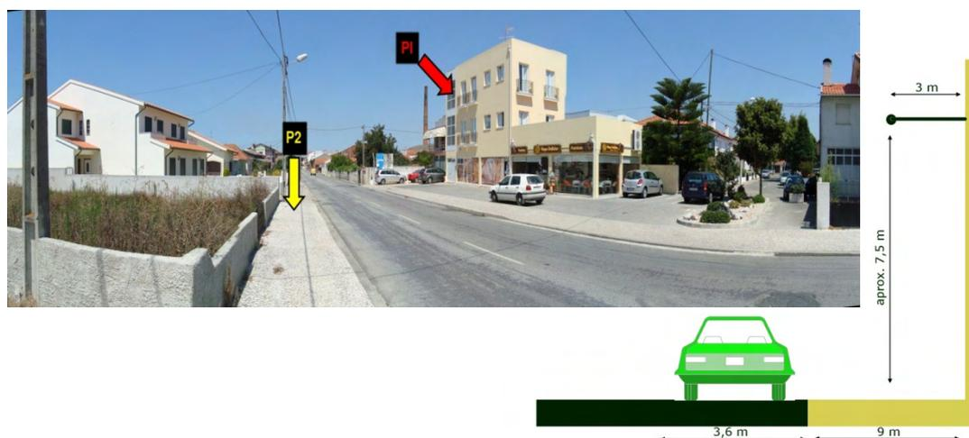
Figura 4.10 - Pontos P2 e PI, e esquema do posicionamento do microfone na medição em PI.
