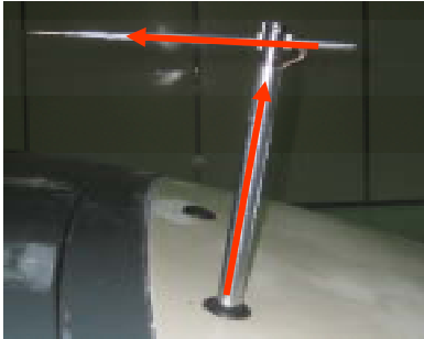
FIG. 3 – Sonde fil chaud montée sur un bras de déplacement, en aval de la césure de hayon.
