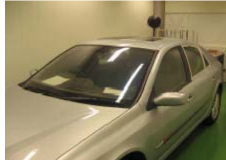
FIG. 4 – Excitation sous champ diffus acoustique en chambre réverbérante.
