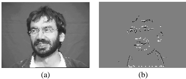
FIG. 3: (a) Image originale avec superposition des points d'intérêt, (b) masques binaires, extraits de la version binaire de (a), dans le voisinage des points d'intérêt.
