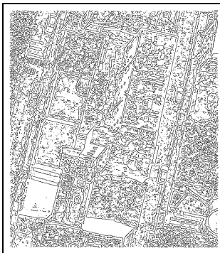
Détection de contours. Filtre de Deriche : \alpha = 2.5
