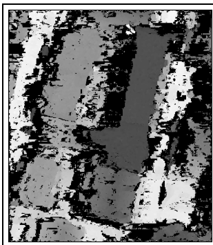
Appariement. Calcul avec 3 niveaux de pyramide. Intervalle de recherche : 100 pixels.
