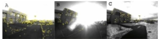
Figure 4. Appariement de points entre une image du flux vidéo (B et C) et l'image clef la plus proche (A). En B, soleil dans le champ de la caméra, en C, sol enneigé. Seuls les appariements corrects sont affichés.
