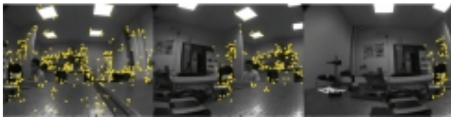
Figure 15. De gauche à droite images prises à 0^\circ , 44^\circ et 90^\circ , avec les points d'intérêt correctement appariés en surimpression.
