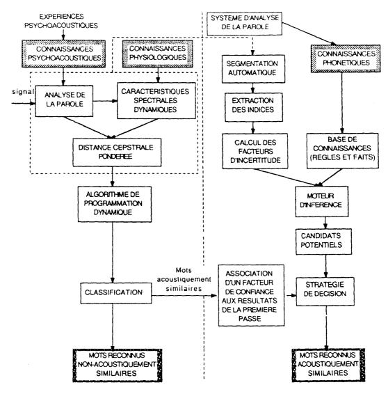
Figure 1. — Diagramme fonctionnel du système hybride ORION (l'entrée du signal de parole se fait au niveau de la chaîne de gauche).
