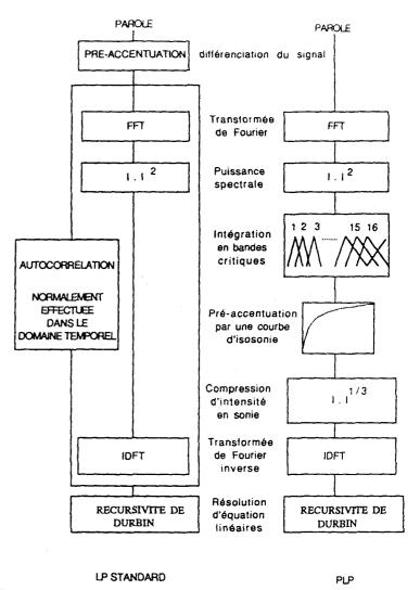
Figure 2. — Diagramme fonctionnel de la technique d'analyse PLP.
