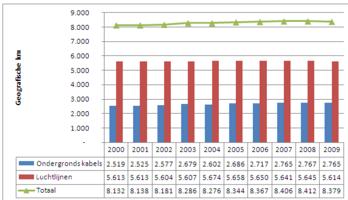
Figuur 123: Evolutie van de geografische lengte (in km) van de hoogspanningsnetten (België, 2000-2009)
