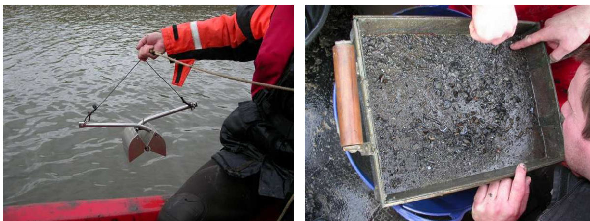
Figuur 6. Van Veen grijper (links) en gezeefd bodemmateriaal (rechts).
