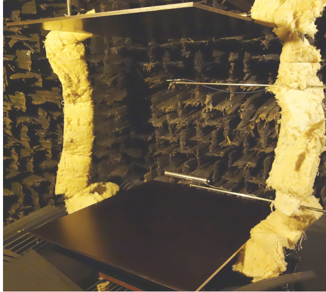
Figur 4.5: Forsøk med parallelle plater med kilde plassert 0.375m fra bunnplaten
