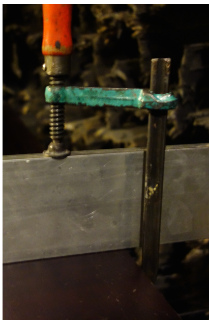
(a) Skrutvinge til feste av aluminiumsbjelke
