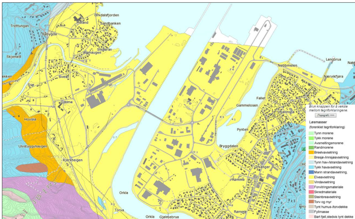
Figur 3.2 – Oversikt over løsmasser i området ved byggested [18]
