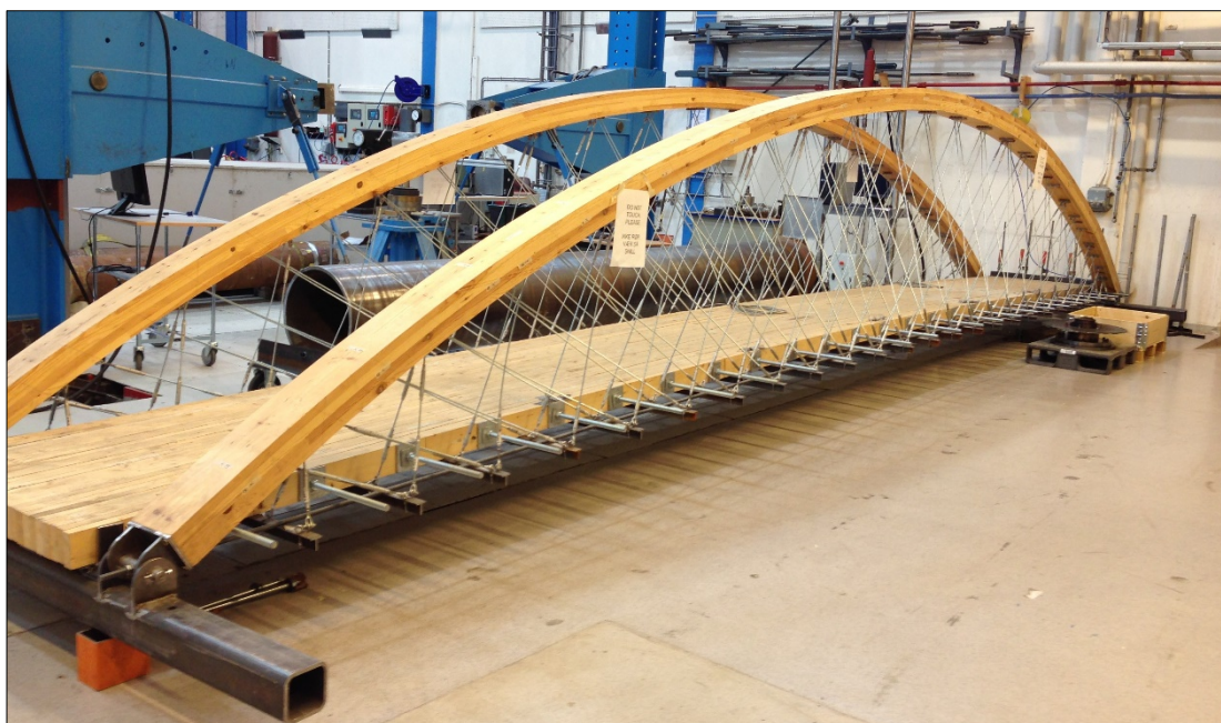
Figur 1.2 – 10 meter lang modell av nettverksbuebru
