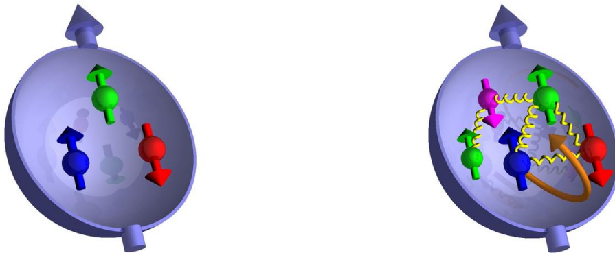
Figuur S.1: Schematische afbeeldingen van de opbouw van de spin van het proton. De pijlen geven de spinrichting van het proton en de quarks weer. Links is aangegeven hoe men voor de spin crisis dacht dat de spin van het proton kon worden gerelateerd aan de spin van de quarks. De rechter afbeelding geeft ons huidige beeld weer, namelijk dat ook de spin van de gluonen (de gele 'veertjes'), de virtuele quarks (iets kleiner afgebeeld) en de baanbeweging van quarks en gluonen (aangegeven door de oranje pijl) een belangrijke bijdrage kunnen leveren aan de totale spin van het proton.
