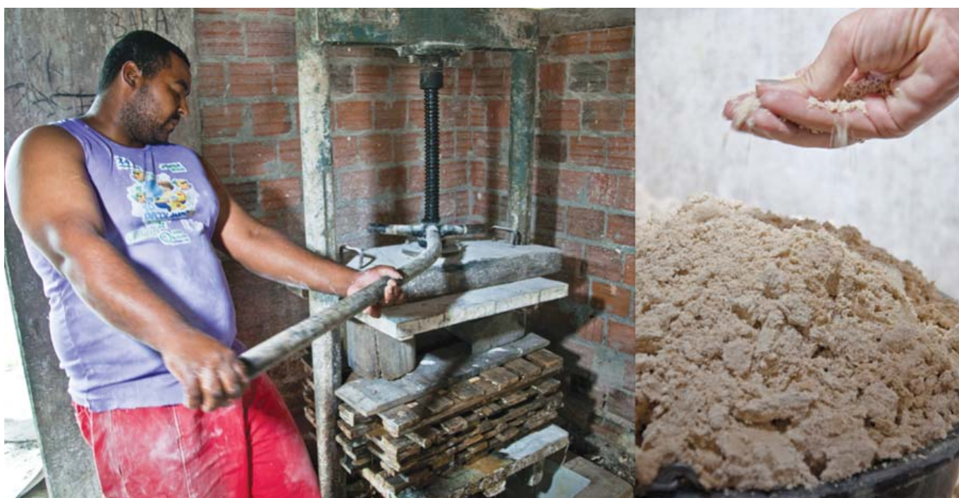
Figura 6. Prensagem da massa resultante da ralação. Da esquerda para direita: prensa e massa prensada.
