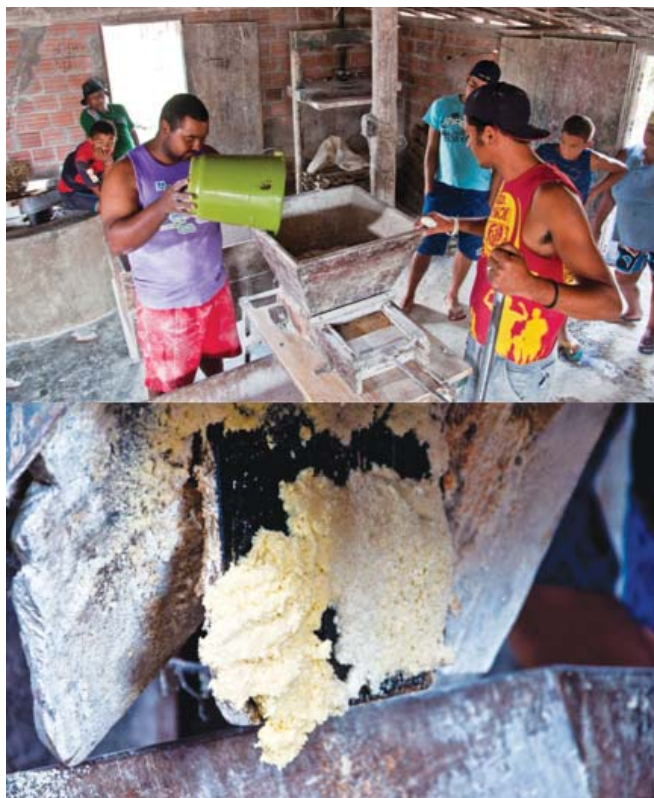
Figura 5. Ralação das raízes tuberosas de batata-doce na casa de farinha no Povoado Barrinha, em Umbaúba, SE, 2012.
