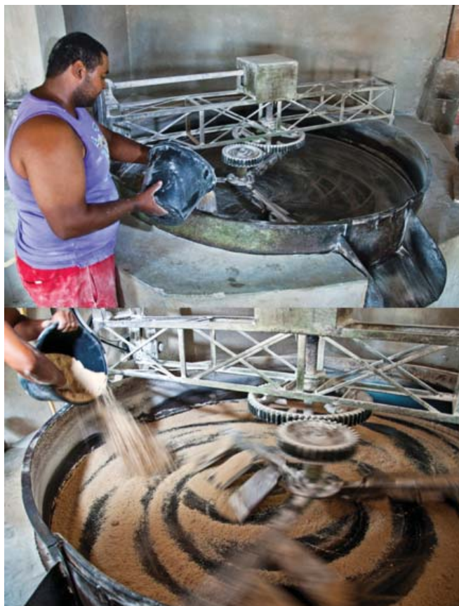
Figura 8. Torração da farinha de batata-doce em forno movido com motor elétrico.
