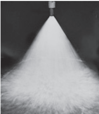
Figura 8. Atomização do líquido em um secador “spray dryer”.
