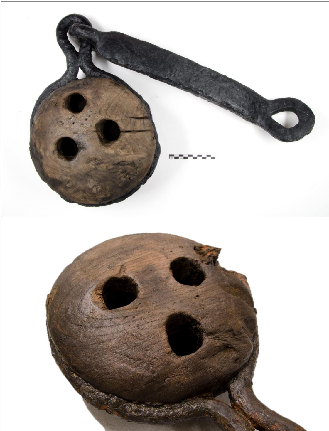
Figuur 39. Het jufferblok met puttingijzer dat in werkpunt 2 werd aangetroffen (G. van Oortmerssen, RUG/GIA).
