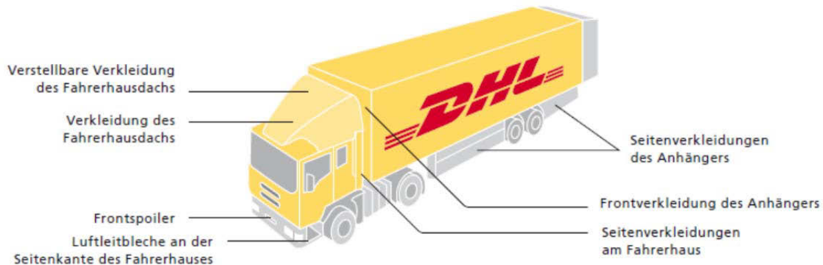
Figure 4: Senkung des Kraftstoffverbrauchs durch Reduktion des Luftwiderstands 16
