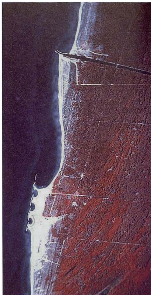
Fig. 7. Visión aérea de los rompeolas del Gombo, nótese la forma en log-espiral de la playa en la zona aguas abajo en erosión (Foto: Autorità di Bacino del Fiume Arno).
