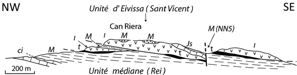
**Fig. 8.** Coupe de la «klippe» de Can Riera. t, Trias supérieur: marnes bariolées; L, Liassic: dolomites; js, Jurassique supérieur: calcaires; ci, Crétacé inférieur: marnes; M, Miocène: conglomérats, marnes du Langhien inférieur à nannoplancton (NN5).
