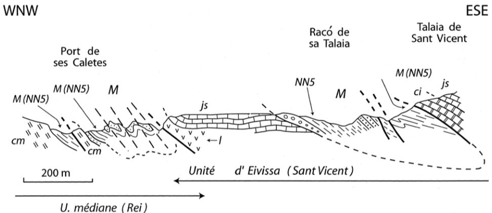
**Fig. 6.** Coupe du littoral nord-est du Port de ses Caletes à la Talaia de Sant Vicent. js, Jurassique supérieur : calcaires en dalles ; ci, Crétacé inférieur : marno-calcaires ; cm, Aptien : dolomites ; M, Miocène : conglomérats, microbrèches, grès, marnes du Langhien inférieur à nannoplancton (NN5). Tireté : schistosité.
