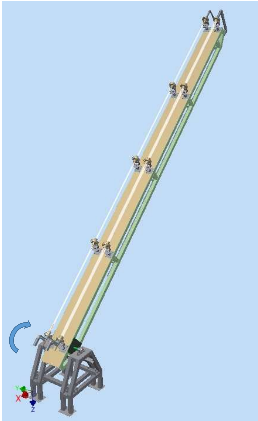
Figura 29: Experimento de Escoamento Bifásico Do LTE/IEN em posição inclinada.
