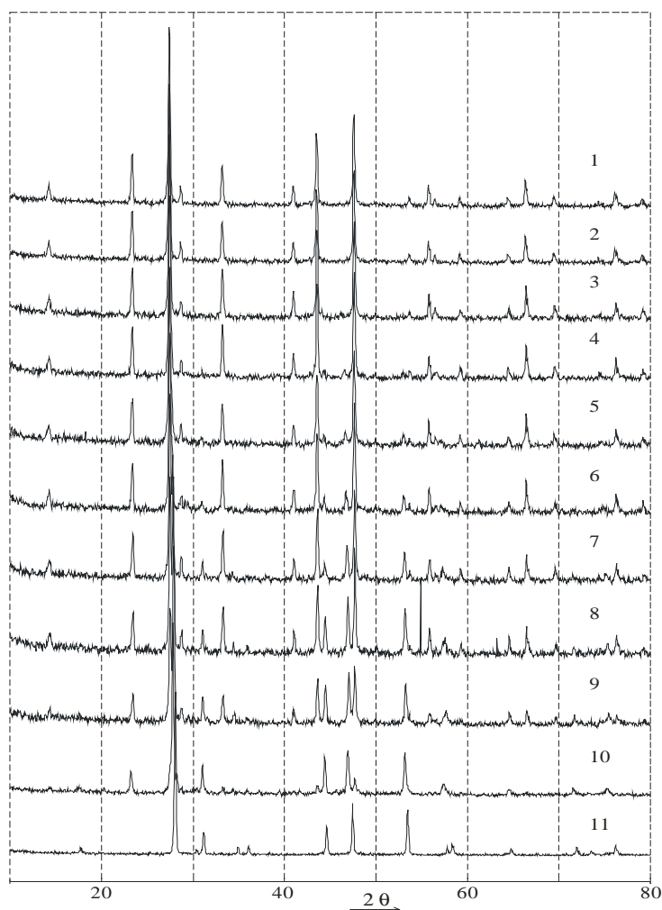
Рис. 2. Дифрактограми сплавів системи \text{AgGaS}_2\text{-AgIn}_5\text{S}_8 при 820 К:
