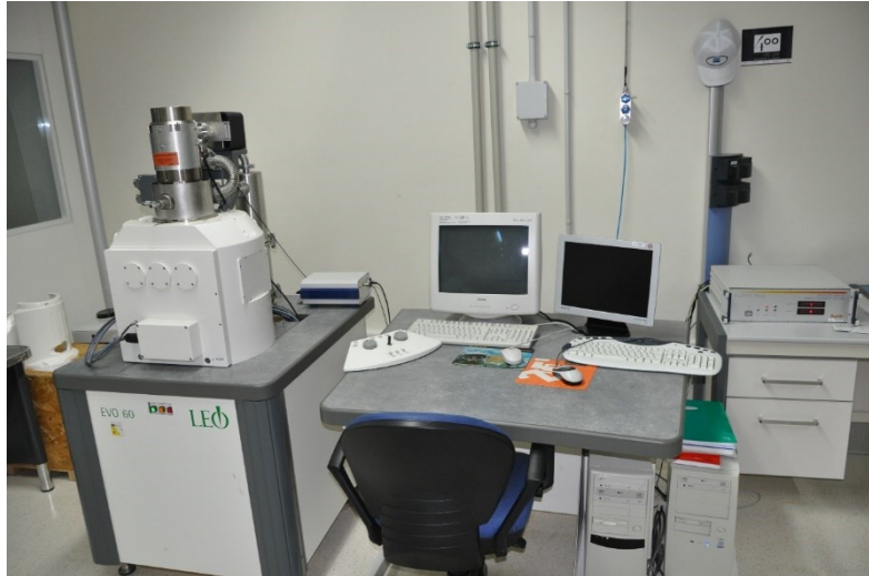
Fig L.1: Equipo usado en los procesos de litografía electrónica de este trabajo: Leo EVO™ 60 de la compañía Carl Zeiss con la columna y cámara principal a la izquierda y a la derecha el sistema electrónico de control de la litografía Elphy Plus de la compañía Rait .
