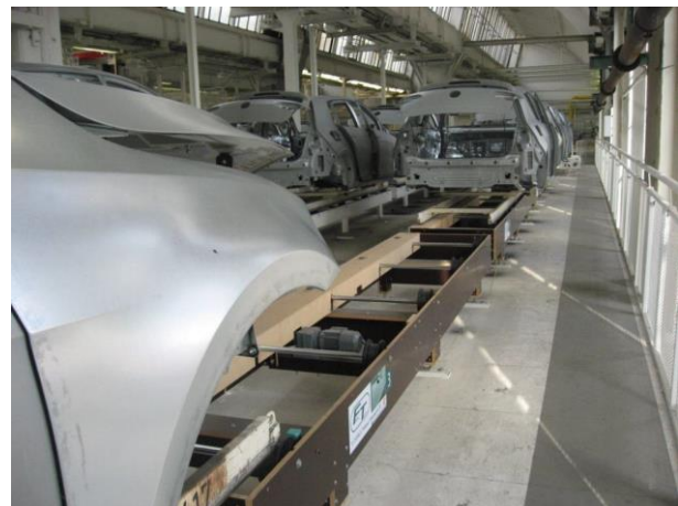
Abbildung 4. Prototypenanlage der Skidförderer in Holzbauweise [FNR14], [HIM17]
