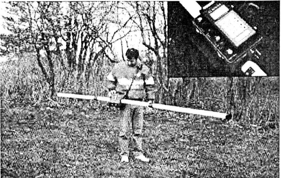
Rys. 2 Widok konduktometru elektromagnetycznego EM31-MK2 przygotowanego do profilowania (w prawym górnym rogu część pomiarowo - rejestrująca)
