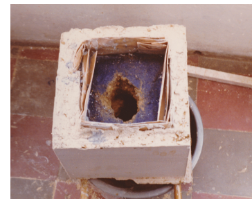
Pijpvorming in een ongestoord grondmonsters
