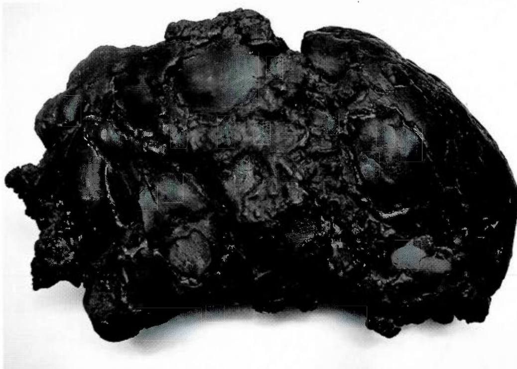
Fig. 196 La combustion d'une mixtion composée de filasse grossière de poudre de silice et de résine non catalysée a produit l'essentiel de cet échantillon. La résine a d'abord été versée sur un tapon de filasse déposée dans de la poudre de silice, puis, suite à quelques jours de compénétration entre la poudre et la résine, l'amas grumeleux a été enflammé. Après une dizaine de minutes, la combustion a été stoppée avec un jet d'eau. Le jet a dégagé une masse solidifiée présentant une composition de craquelures et de surfaces unies d'une douce et séduisante très fine porosité. Le frottement intensif d'un enduit de résine écrue sur quelques unes de ces surfaces a finalisé le rendu d'une matière suggérant indistinctement des références au bois, au cuir, au métal et à la pierre.
