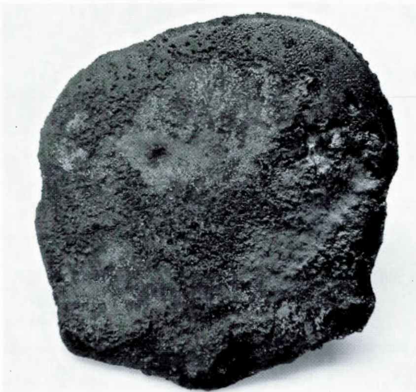
Fig. 60 Projection de gouttes d'eau colorée sur une mixtion composée de résine liquide et de poudre de silice pigmentée.
