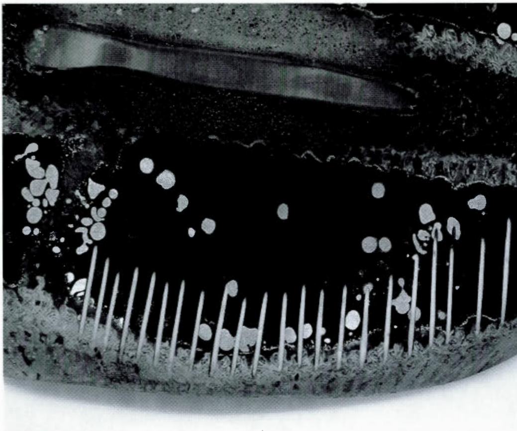
Fig. 188 Détail d'un échantillon. Les lignes blanches verticales résultent d'une abrasion suivant le comblement avec de la résine colorée de petites rainures faites avec un outil rotatif. Elles « traversent » composite tissulaire, résine colorée et parfois du plomb (petites formes arrondies).
