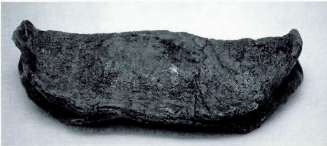
Fig. 110 Échantillon composé de résine de polyester et de résine de polyuréthane. La flexibilité du composé a permis le replis pendant la fige.
