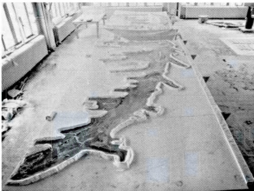
Fig. 143 Moulage progressif. Les bordures extérieures et les portées intérieures ont été réalisées en poudre de plâtre. Suivant la fige des coulées, les surplus non imprégnés des portées intérieures ont été retirés avec un aspirateur. Huit couches d'un fin tissu de fibre de verre ont ensuite été appliqués avant de procéder à une seconde séquence de coulée. Le processus se sera étalé sur plus de huit mois.
