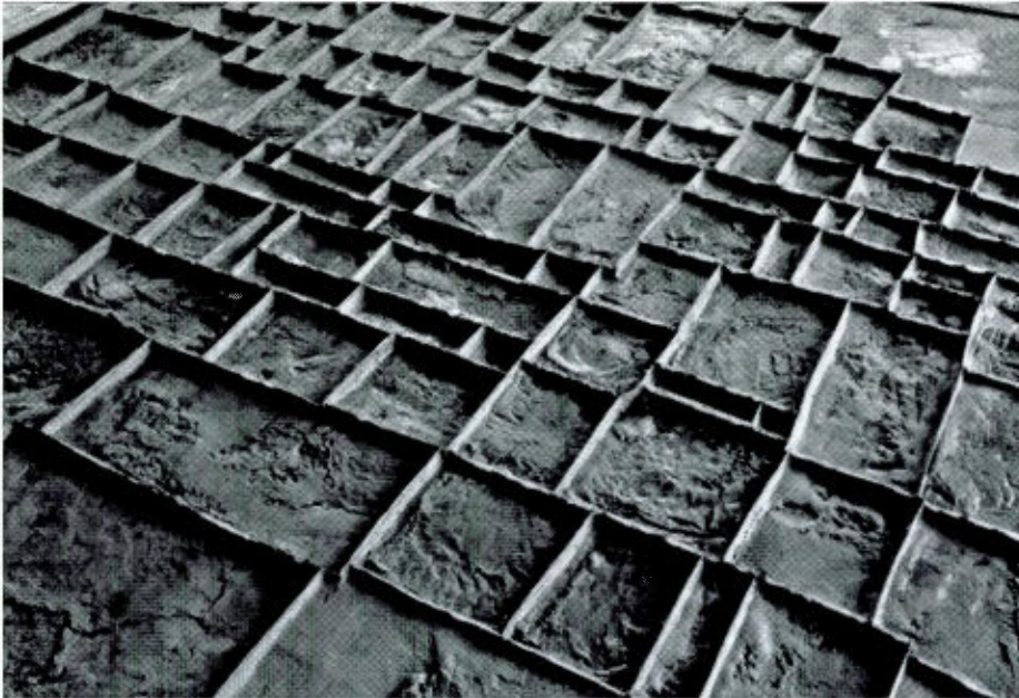
Fig. 148 Vue partielle d'un des moules de 299 Pierre de taille . Le façonnage des moules des deux murs aura exigé plus de cinq mois de travail. Des cloisons en feuilard de polypropylène, incluses dans l'argile et retirées au démoulage, ont permis la figuration d'un faux ajustement par taille directe.
