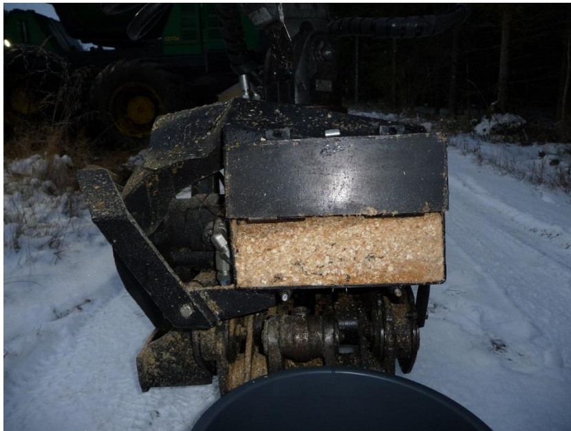
Kuva 5. Tutkimuksessa käytetyn näytteenottolaitteen purusäiliö (Kuva: Lasse Tuunanen)
