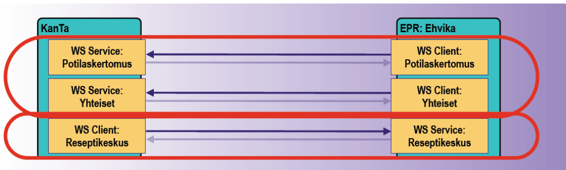
Kuva 21: Potilaskertomus- ja Yhteiset- rajapinnat tarjoavat palvelumetodeja, joita potilastietojärjestelmä voi kutsua, esim. uuden reseptin lisääminen arkistoon. Reseptikeskus-rajapinta tarjoaa rajapinnan, jota KanTa voi kutsua (reseptin uusimispyyntö) (Kauppi 2010).
