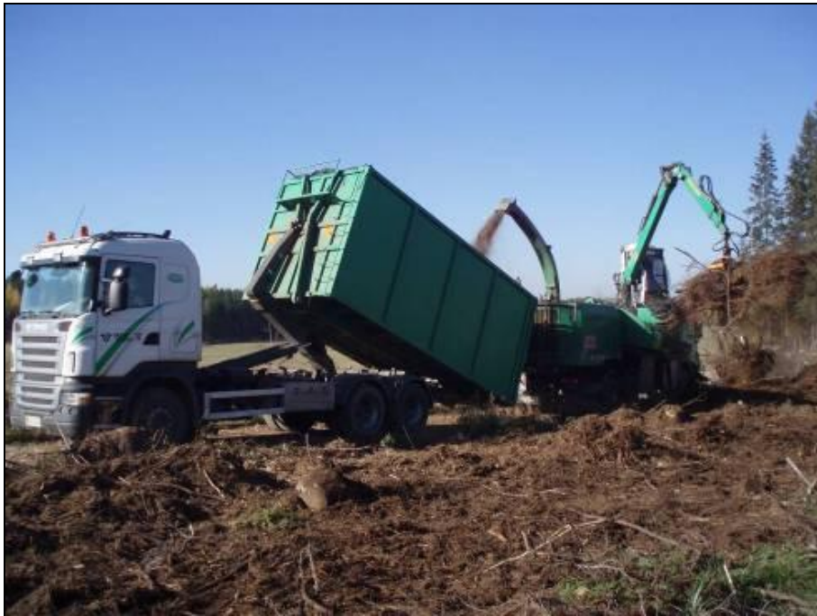
Kuva 6. Metsätähteen tienvarsihaketukselta hakkuri-hakeauto -yhdistelmällä (kuva M. Ruokolainen).
