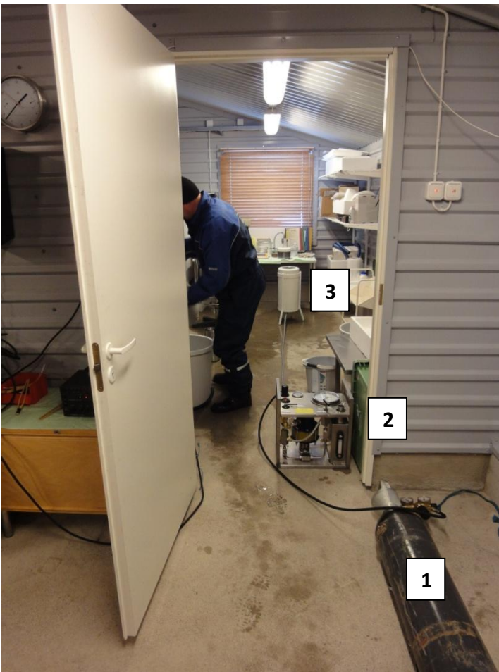
Kuva 9. Paineshokkiin käytettävä laitteisto Tervon RKTL:n laitoksella. Kaasukäyttöisen (1) nestepumpun (2) tuottama hydrostaattinen paine ohjataan triploidiakammioon (3), jonne vastahedelmöitetty mätimunat aluksi laitetaan. Kuva: A. Nousiainen 2010, RKTL Tervo.
