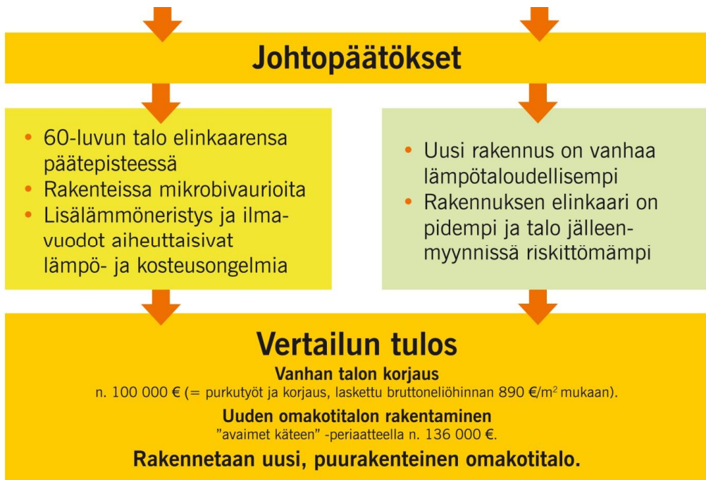
Taulukko 7. Johtopäätös tutkittavana olevasta omakotitalosta
