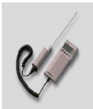
Kuva 13. Betoninkosteudenmittauslaite Vaisala HM141
