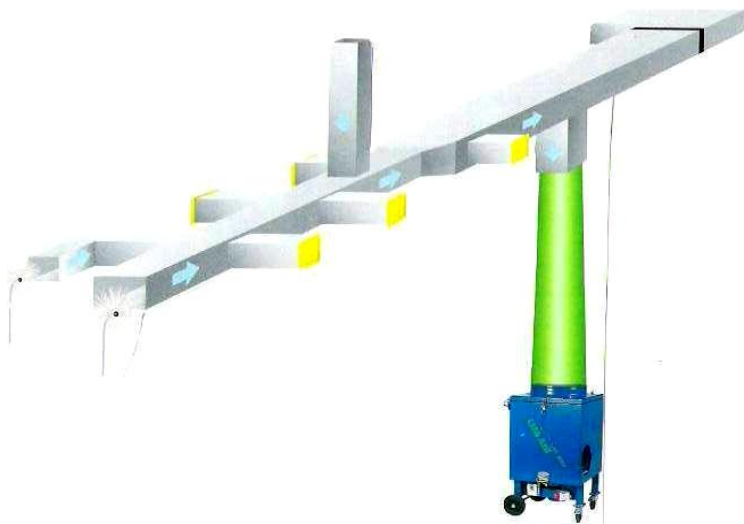
Kuva 10. Periaatekuva kuvaa kanavien puhdistuksesta sekä järjestyksestä. ( Lifa Airi(tuote-esite).
