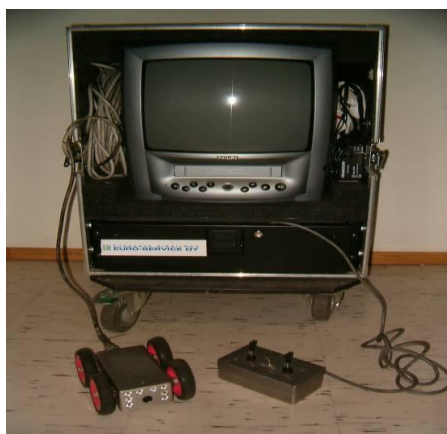
Kuva 1. Kanaviston puhtauden arviointiin käytettävä kameralaitteisto.
