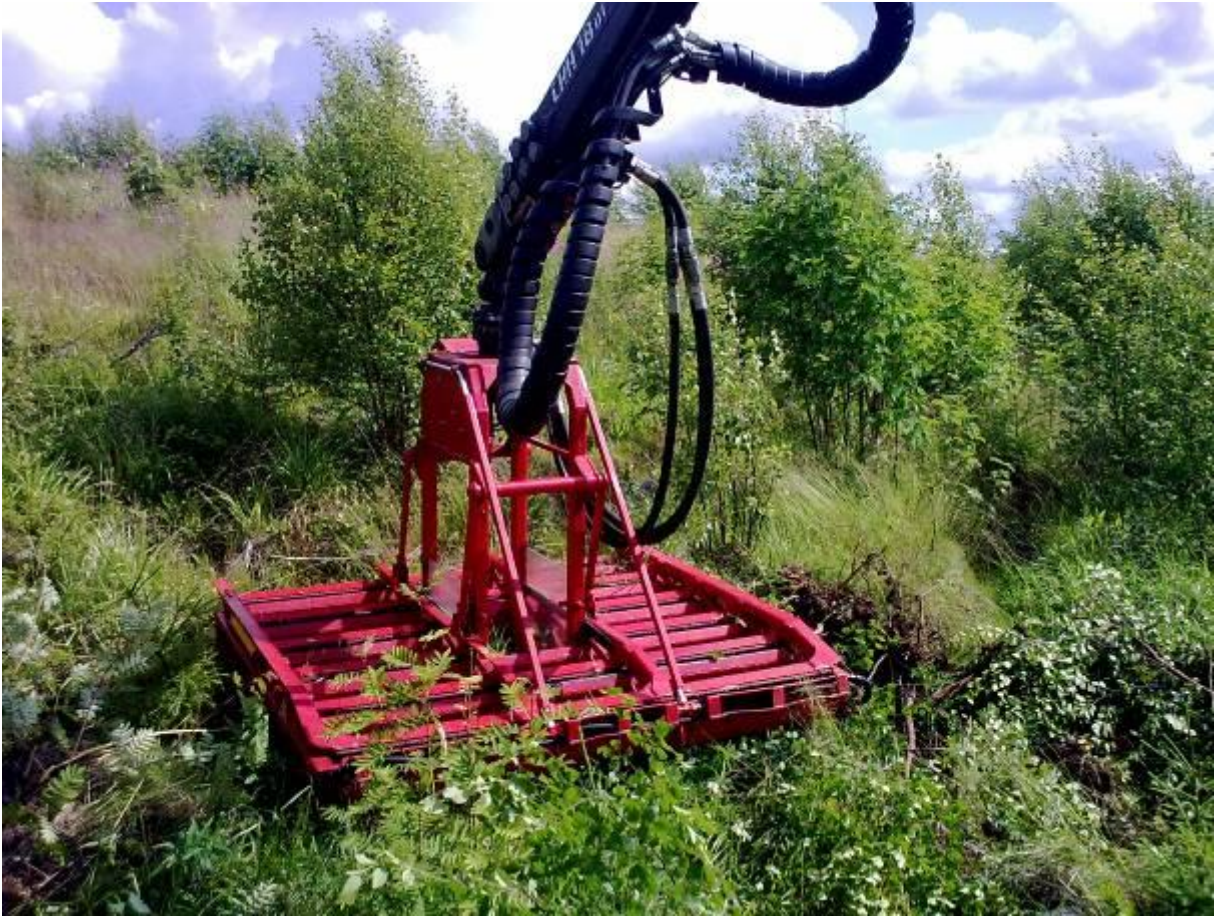
Kuva 1. Kitkevä Naarva-reikäperkaaja. Laite kiinnitetään harvesteriin hakkuukouran tilalle.
