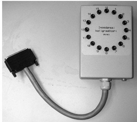
Kuva 6.32: Tarkkuusvastuksista koottu renkaanmuotoinen kalibrointifantomi, Kalibraattori.
