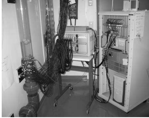
Kuva 8.1: KIT2-laitteisto kytkettynä virtausputkifantomiin.
