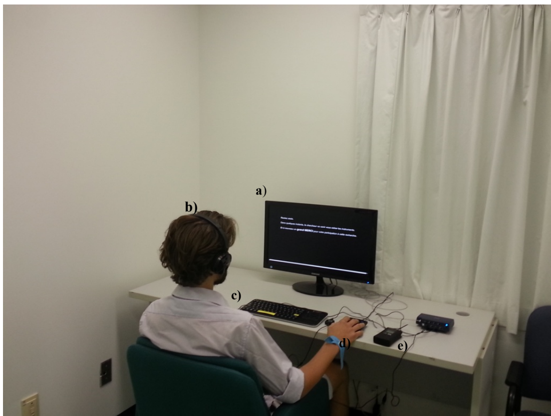
Figure 26. Photo du dispositif expérimental : a) écran cloné, b) casque audio sans fil, c) clavier, d) pavé numérique, et e) éthylotest.
