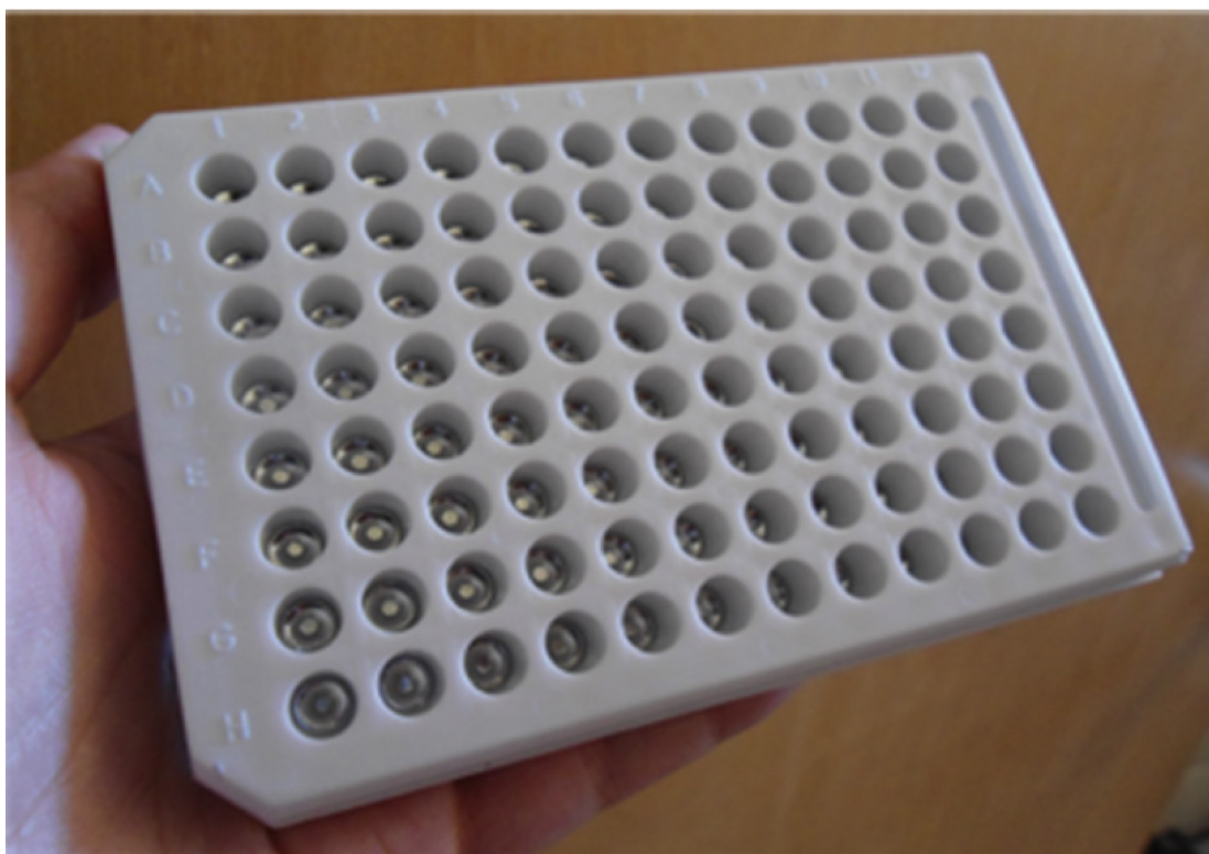
Figure 1-11. Exemple d'une plaque Lazwell à 96 puits pour les analyses en LDTD-APCI.
