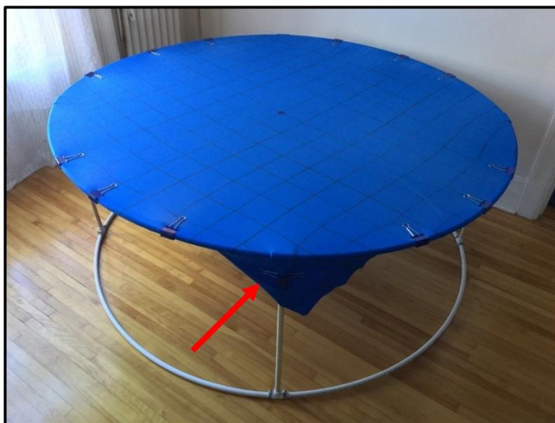
Figure 39. Montage final du simulateur de gravité, après l'installation du tissu extensible. La flèche rouge pointe une des quatre pinces qui retiennent le tissu extensible aux poteaux de la structure; cela contribue à stabiliser le tissu mais aussi toute la structure en pvc.
