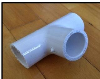
Figure 32. Coupleur de plomberie en forme de T, pvc,  $\frac{1}{2}$ " (12,7 mm).
